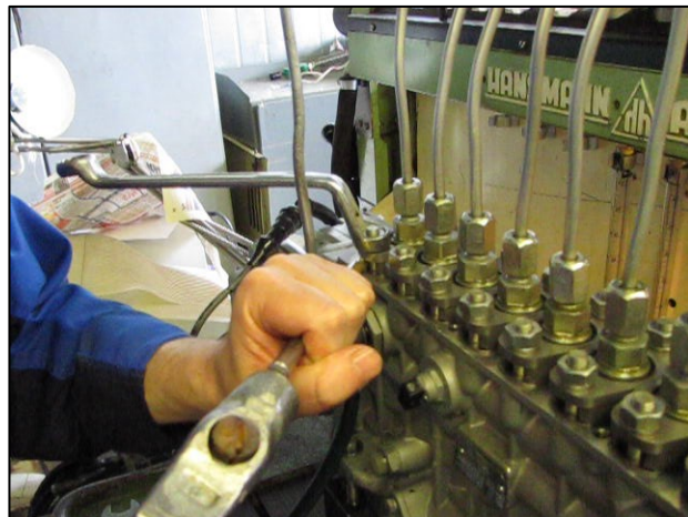
Рис. 3.225 – Подрегулировка неравномерности подачи топлива по секциям
