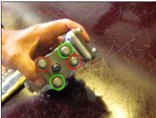
Рис. 3.129 – Порядок отворачивания болтов
