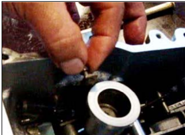
Рис. 3.123 – Установка ролика рычага рейки
