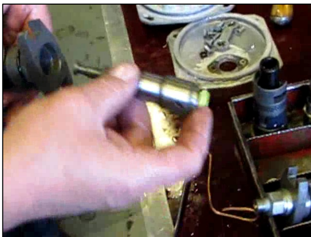
Рис. 3.61 – Установка плунжерной пары.
