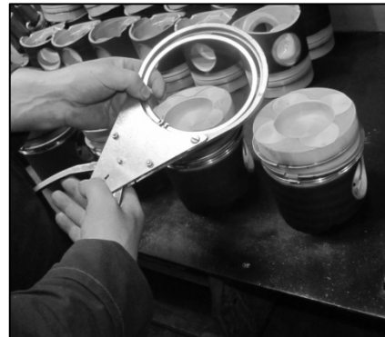
Рис. 3.6 – Снятие поршневых колец
