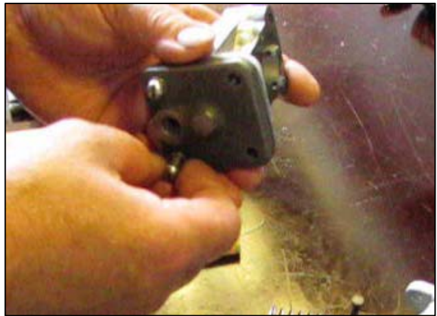
Рис. 3.132 – Снятие крышки мембраны
