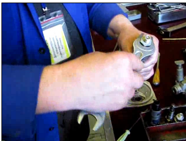
Рис. 3.68 – Установка штуцера секции
