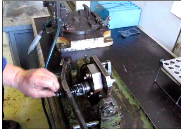
Рис. 3.73 – Установка нижней тарелки пружины
