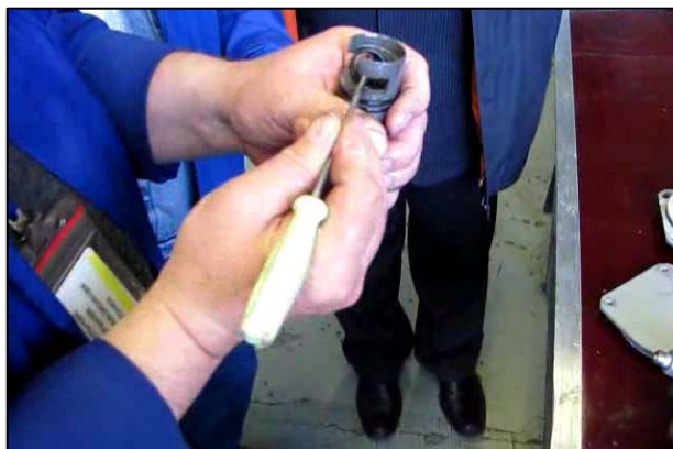
Рис. 3.57 – Снятие резиновых уплотнений
