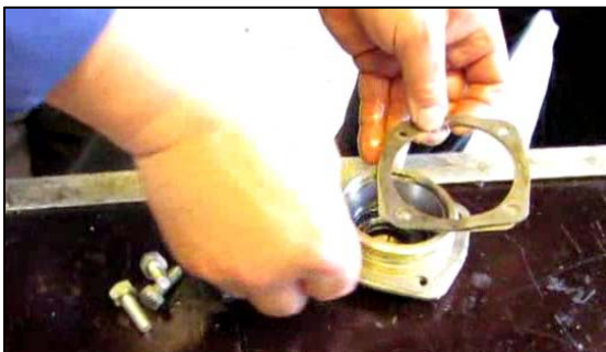
Рис. 3.163 – Установка пакета прокладок на крышку подшипника
