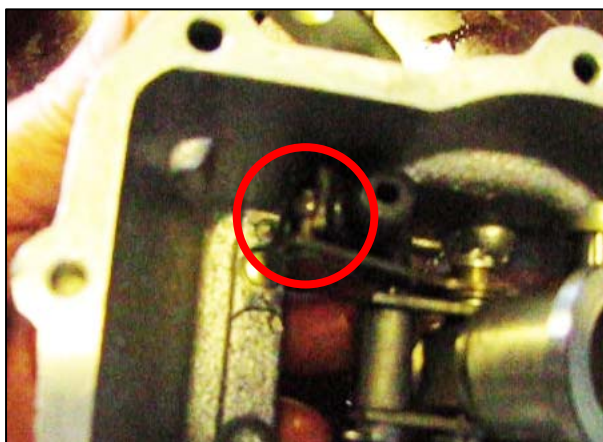
Рис. 3.124 – Установка ролика в паз кулисы
