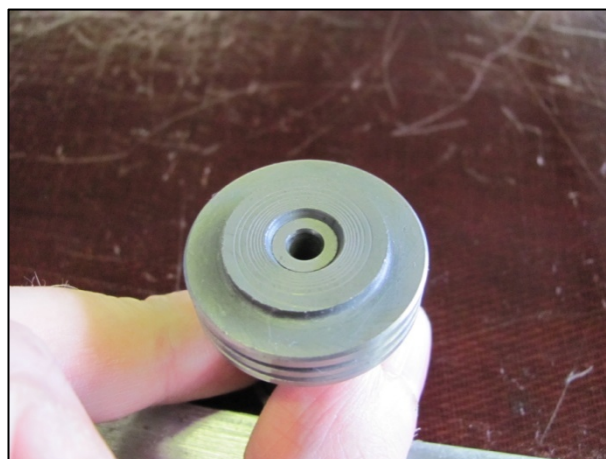
Рис. 3.138 – Правильное положение поршня относительно золотника
