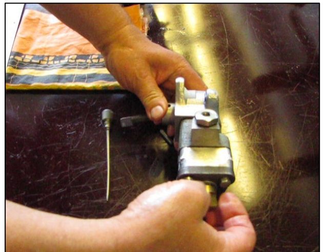
Рис. 3.127 – Снятие колпака винта регулировки пружины
