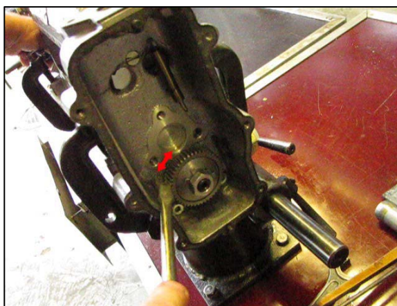
Рис. 3.167 – Затяжка гайки демпфера
