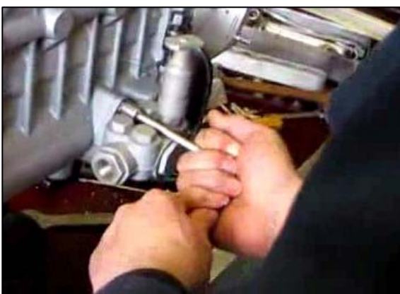
Рис. 3.46 – Снятие топливоподкачивающего насоса
