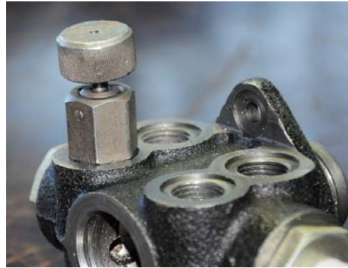
Рис. 3.87 – Установка приспособления в корпусе ТПН
