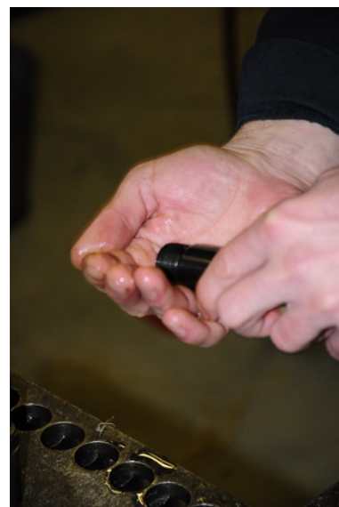
Рис. 3.239 – Снятие распылителя форсунки
