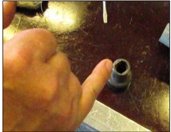
Рис. 3.82 – Спецключ для демонтажа втулки
