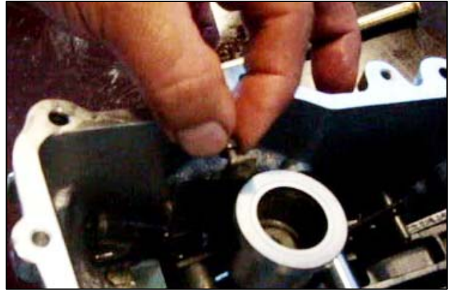
Рис. 3.93 – Снятие ролика с оси рычага рейки
