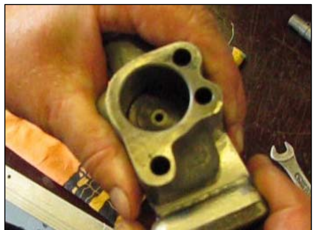
Рис. 3.144 – Регулировка положения золотника относительно поршня
