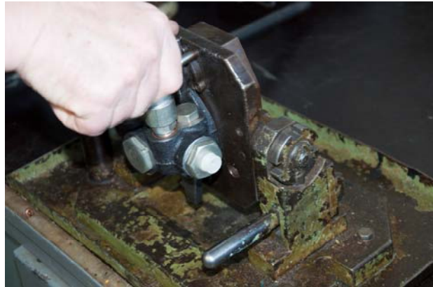
Рис. 3.90 – Установка пробок клапанов и топливопрокачивающего насоса
