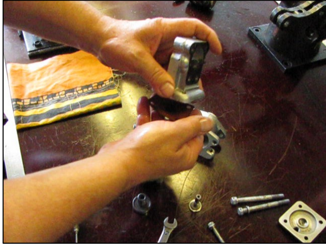
Рис. 3.134 – Снятие мембраны корректора
