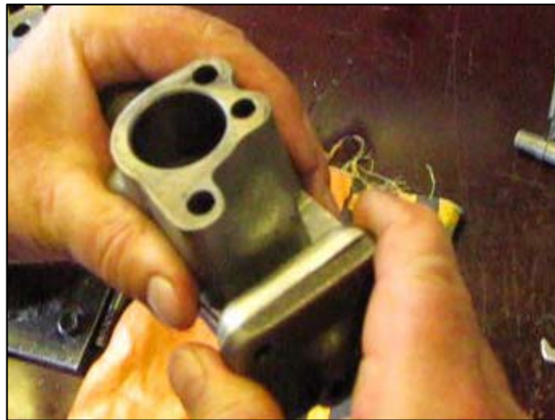
Рис. 3.146 – Установка крышки мембраны
