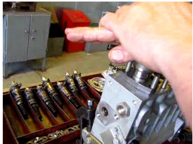
Рис. 3.177 – Установка секции в корпус ТНВД
