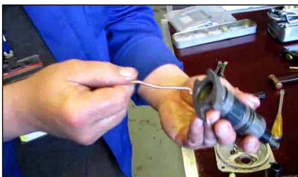
Рис. 3.63 – Разворот втулки плунжера
