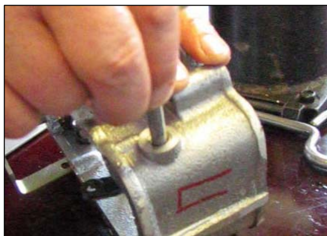
Рис. 3.110 – Проверка выработки втулок оси двуплечего рычага
