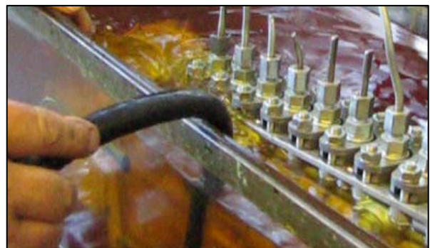
Рис. 3.202 – Опустить ТНВД в ванну с дизельным топливом
