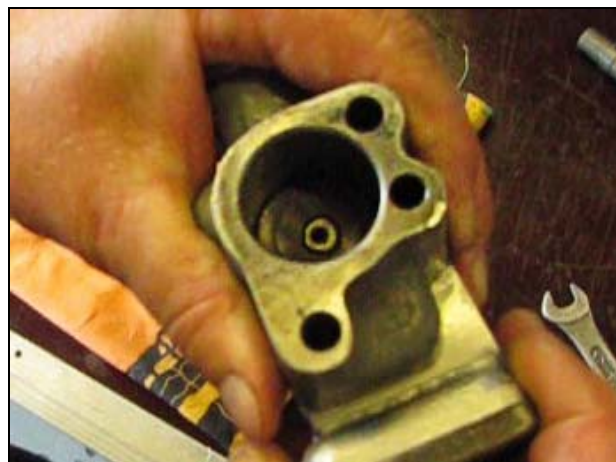
Рис. 3.147 – Проверка положения золотника относительно поршня
