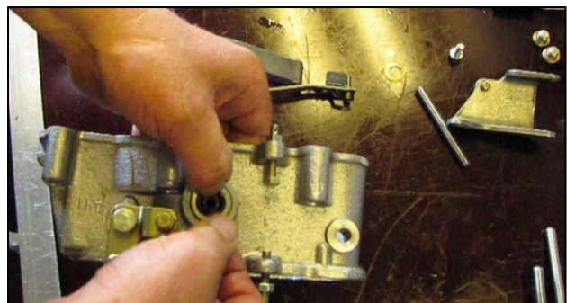
Рис. 3.116 – Установка резинового уплотнения
