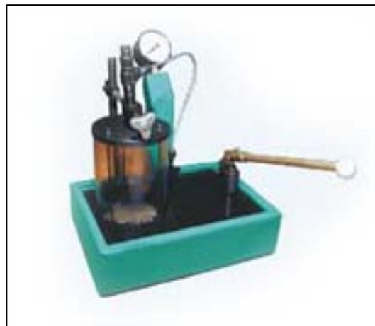
Рис. 3.236 – Стенд для проверки форсунок типа КИ-3333.
