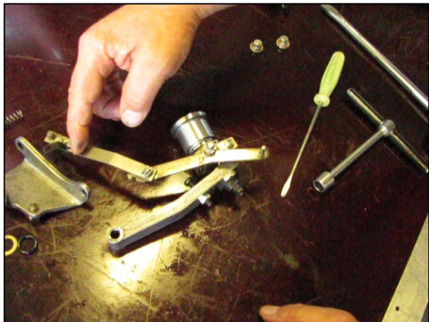
Рис. 3.112 – Осмотр рычагов и тяг
