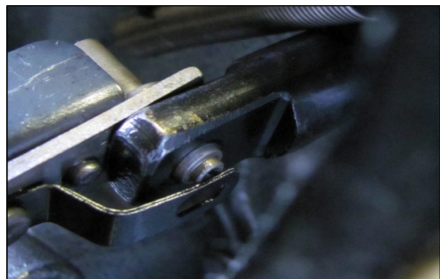
Рис. 3.38 – Отсоединение тяги рейки ТНВД
