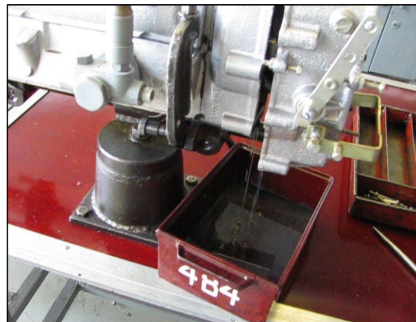
Рис. 3.37 – Слив масла из полости регулятора ТНВД
