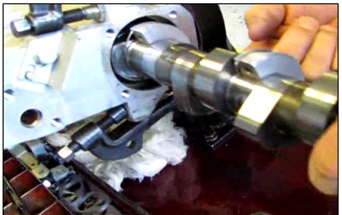
Рис. 3.160 – Установка кулачкового вала
