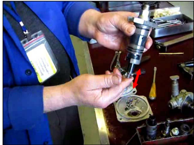
Рис. 3.70 – Проверка подвижности плунжера
