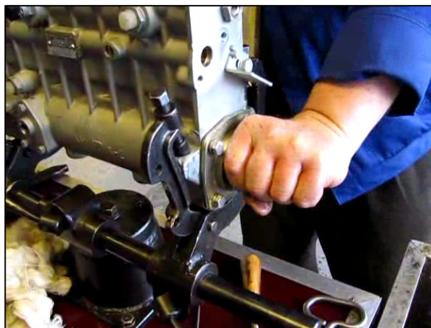
Рис. 3.165 – Проверка вращения кулачкового вала
