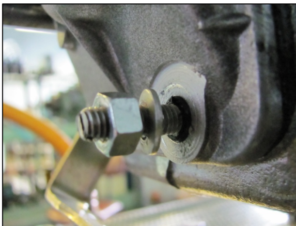
Рис. 3.198 – Установка уплотнения на винт подрегулировки мощности
