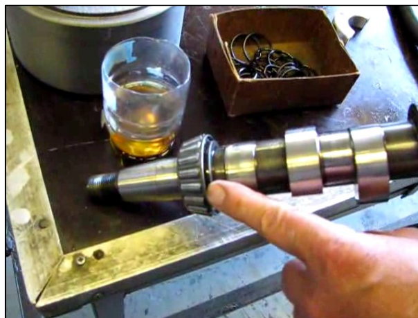
Рис 3.154 – Проверка состояния подшипников
