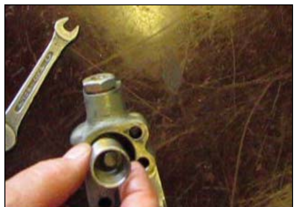
Рис. 3.150 – Установка пружины поршня
