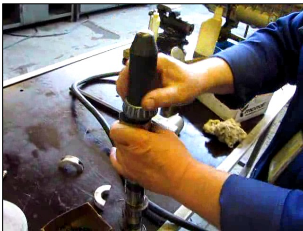
Рис. 3.155 – Запрессовка подшипника на кулачковый вал
