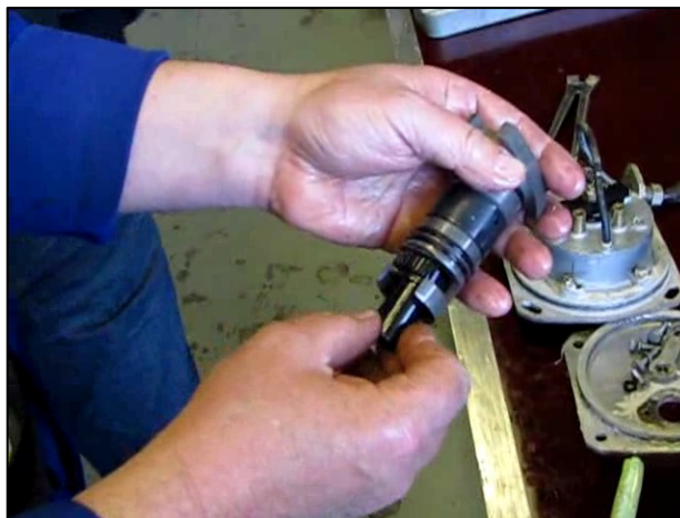
Рис. 3.55 – Снятие поворотной втулки
