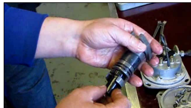
Рис. 3.60 – Установка поворотной втулки
