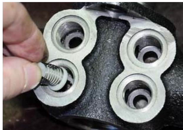
Рис. 3.89 – Установка клапанов с пружинами
