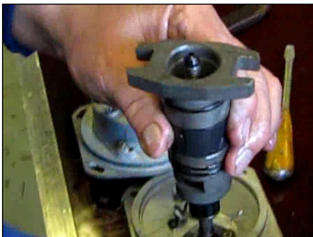
Рис. 3.67 – Установка пружины и упора клапана
