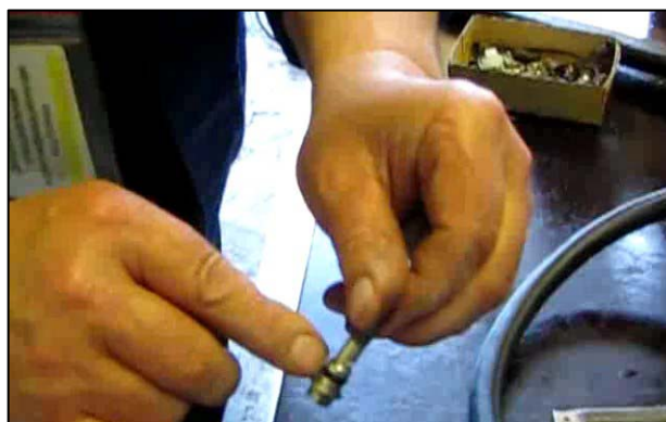
Рис. 3.157 – Смазка резиновых уплотнений
