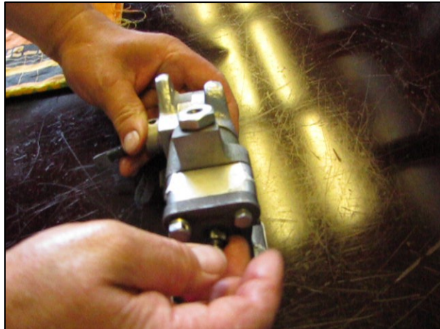
Рис. 3.128 – Ослабление пружины золотника
