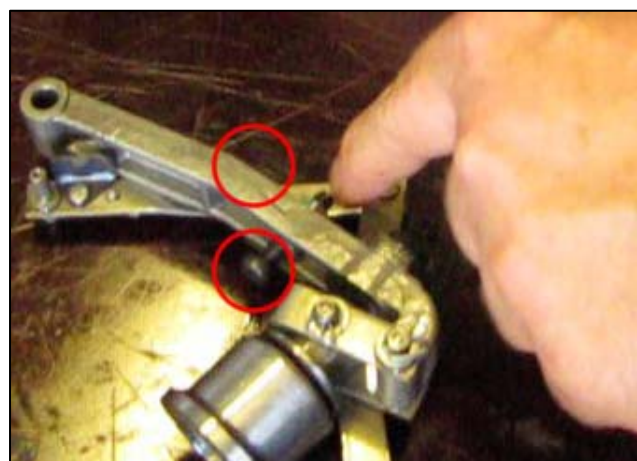
Рис. 3.109 – Места контакта регулировочных винтов
