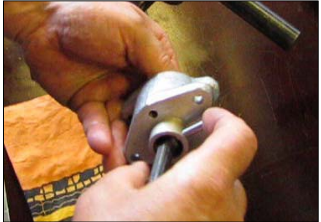
Рис. 3.148 – Установка рычага и оси рычага корректора.
