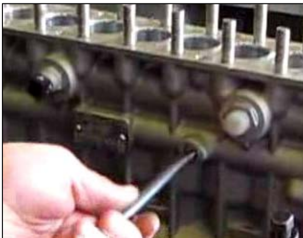
Рис. 3.39 – Отворачивание стопорного винта рейки ТНВД
