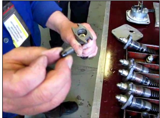
Рис. 3.53 – Снятие упора и пружины нагнетательного клапана
