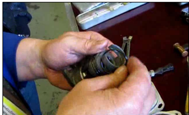
Рис. 3.58 – Правильная установка экрана секции
