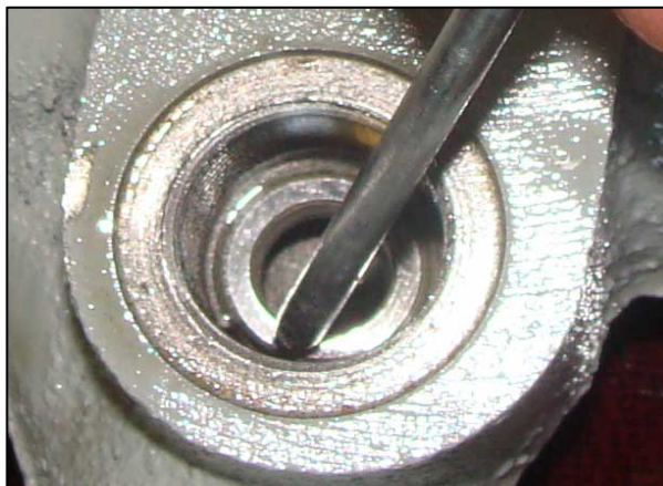
Рис. 3.85 – Осмотр сёдел клапанов
