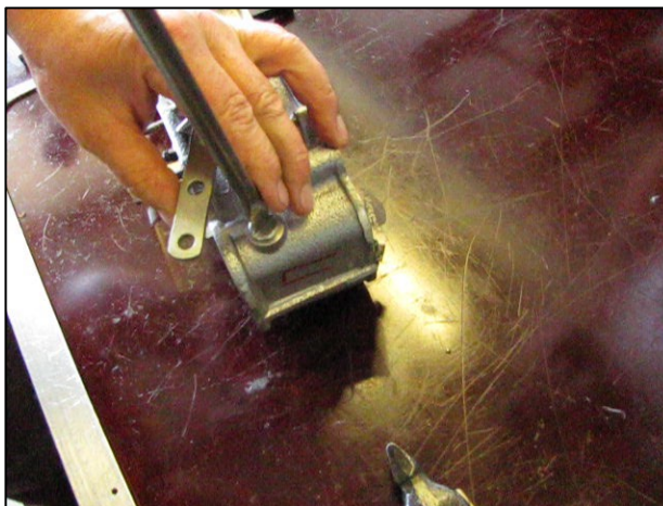
Рис. 3.95 – Снятие пробок двуплечего рычага
