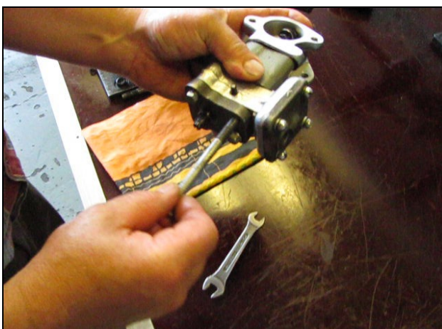
Рис. 3.152 – Крепление проставки корректора к корпусу
