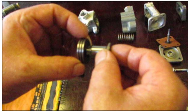
Рис. 3.135 – Проверка состояния поршня и золотника
