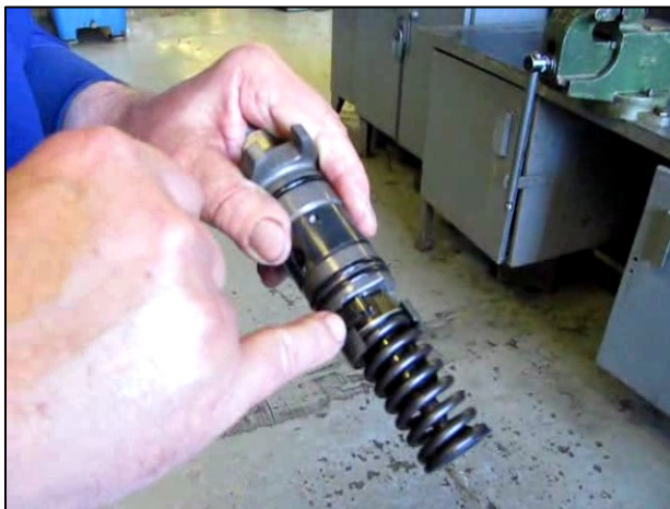
Рис. 3.173 – Правильное положение поворотной втулки секции перед установкой
