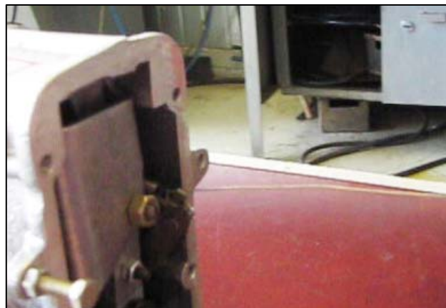
Рис. 3.35 – Снятие пружины рычага рейки
