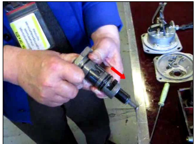
Рис. 3.64 – Установка втулки плунжера
