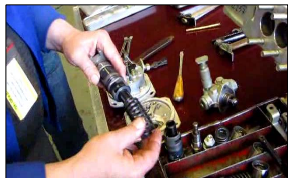
Рис. 3.72 – Установка верхней тарелки и пружины секции
