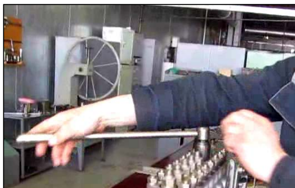
Рис. 3.29 – Ослабление штуцеров секций
