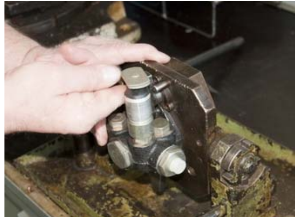
Рис. 3.76 – Демонтаж топливопрокачивающего насоса
