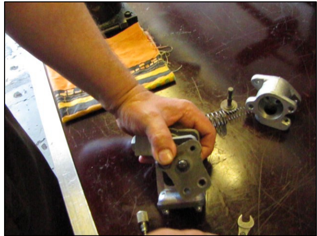
Рис. 3.131 – Снятие крышки корректора.
