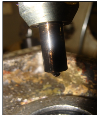
Рис. 3.237 – Проверка герметичности распылителя
