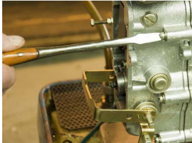
Рис. 3.36 – Снятие крышки регулятора
