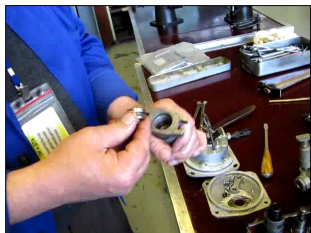
Рис. 3.66 – Установка нагнетательного клапана
