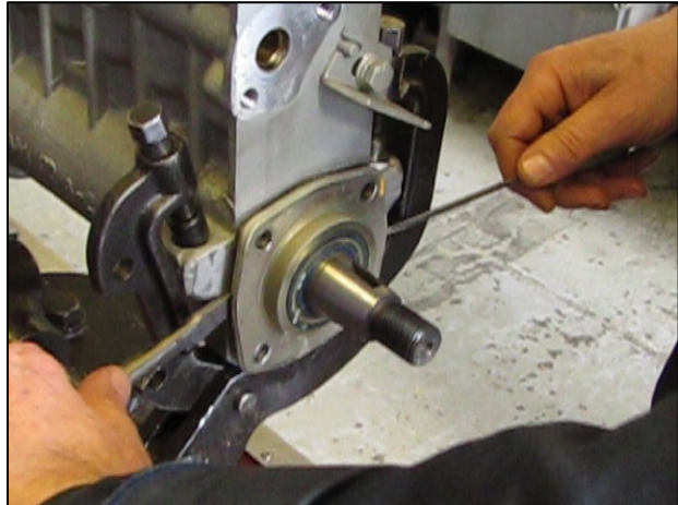
Рис. 3.48 – Демонтаж крышки подшипника
