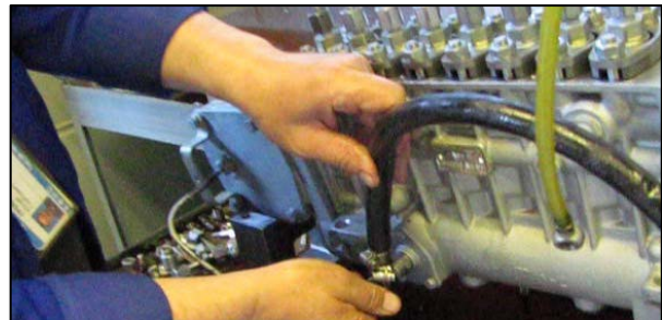
Рис. 3.201 – Подсоединение воздуха к масляной полости ТНВД
