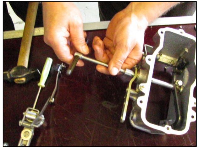
Рис. 3.99 – Снятие рычага управления
