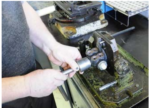
Рис. 3.77 – Ослабить пробку пружины
