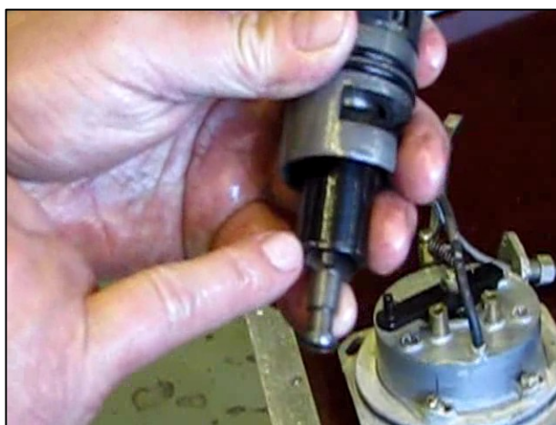
Рис. 3.62 – Правильное расположение плунжера относительно втулки
