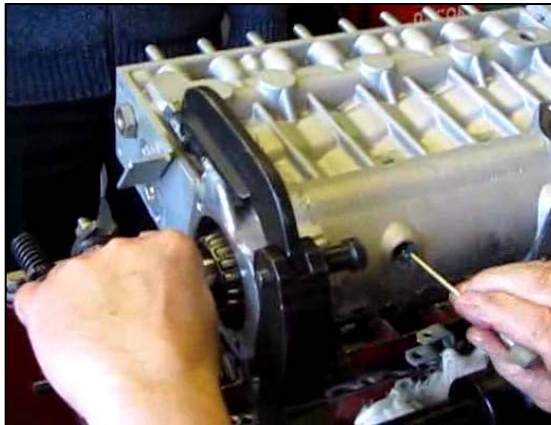
Рис. 3.161 – Совмещение отверстий под крепёжные винты
