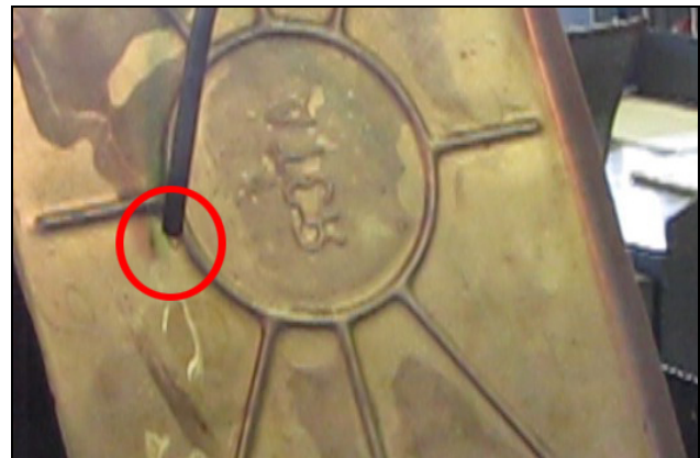
Рис. 3.216 – Окончание истечения топлива из штуцера ТНВД
