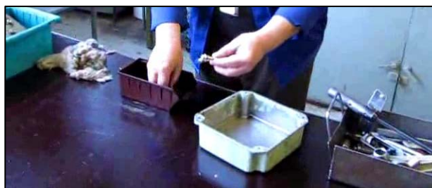
Рис. 3.156 – Обезжиривание промежуточных опор и винтов
