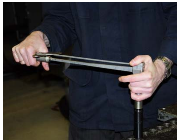
Рис. 3.238 – Снятие гайки распылителя
