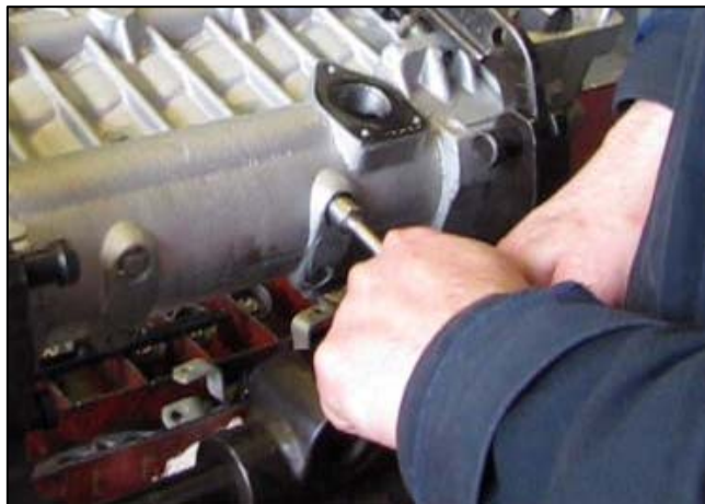
Рис. 3.49 – Отворачивание болтов промежуточных опор
