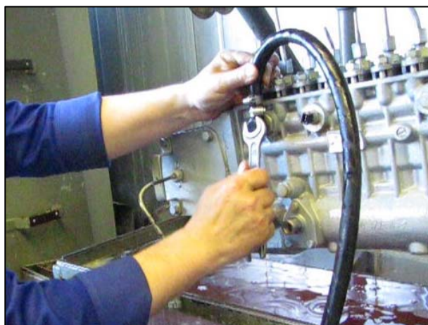
Рис. 3.204 – Подсоединение воздуха к магистрали низкого давления
