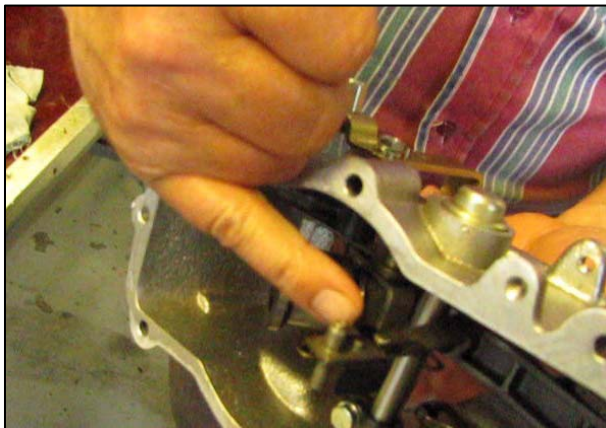
Рис. 3.185 – Расстегнуть фиксатор рейки
