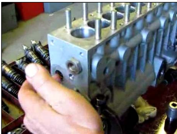
Рис. 3.174 – Положение рейки при установке секций высокого давления
