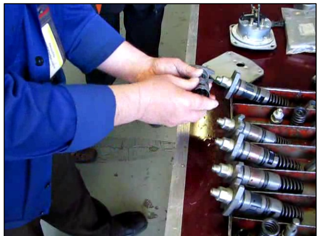
Рис. 3.54 – Демонтаж плунжерной пары
