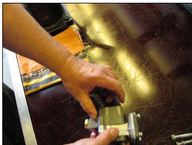
Рис. 3.130 – Снятие проставки корректора
