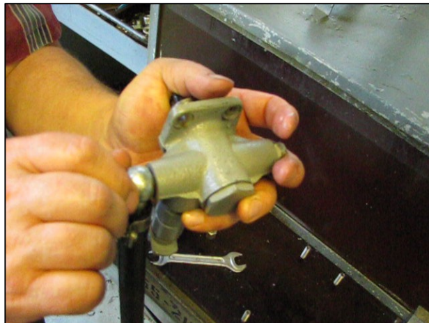
Рис. 3.91 – Подготовка ТПН к проверке на герметичность
