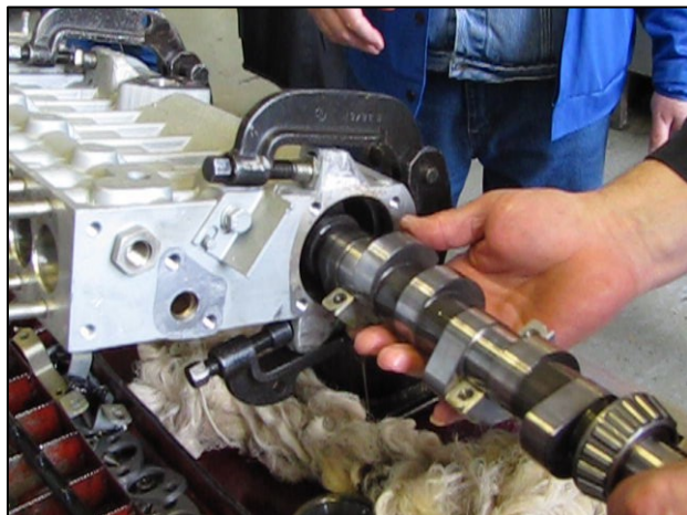
Рис. 3.50 – Демонтаж кулачкового вала
