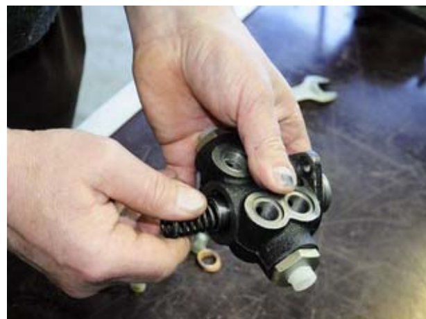
Рис. 3.78 – Снятие пружины и поршня
