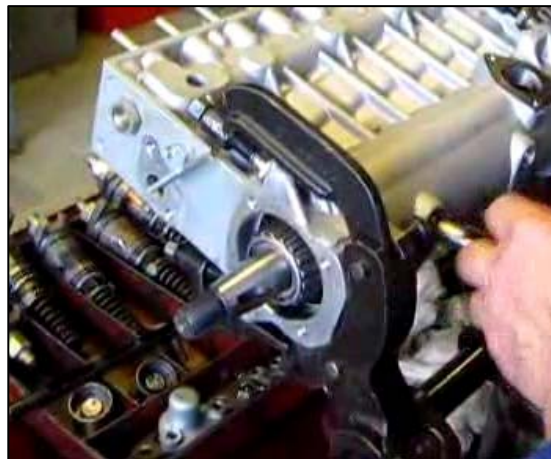
Рис. 3.162 – Затяжка винтов крепления промежуточных опор
