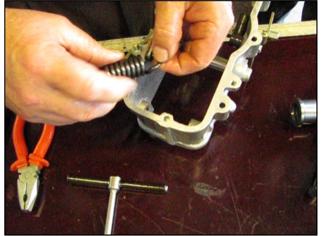
Рис. 3.98 – Отсоединение главной пружины
