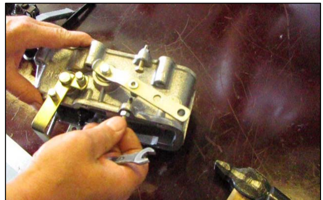
Рис. 3.94 – Снятие винта регулировки холостого хода
