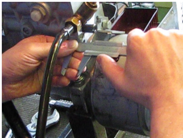
Рис. 3.211 – Установка рейки ТНВД в положение номинальной подачи
