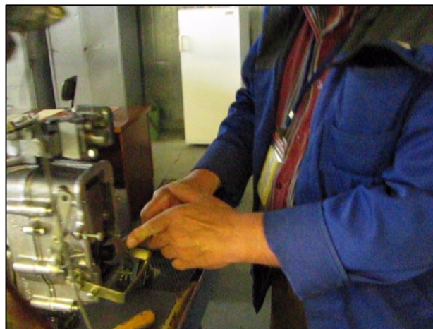
Рис. 3.229 – Регулировка прямого корректора
