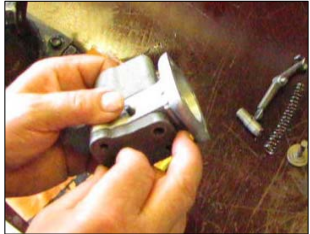
Рис. 3.142 – Установка крышки корректора
