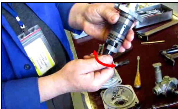
Рис. 3.69 – Проверка подвижности поворотной втулки
