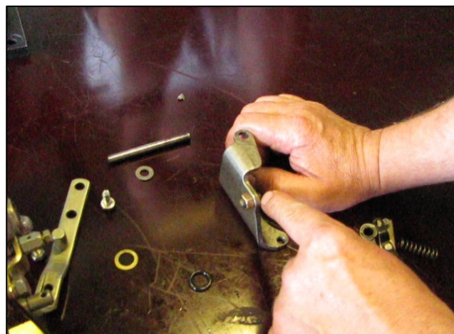
Рис. 3.108 – Осмотр двуплечего рычага
