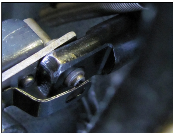
Рис. 3.187 – Соединение рейки с тягой рейки
