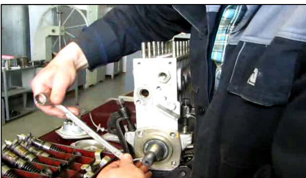
Рис. 3.47 – Снятие болтов крепления крышки подшипника
