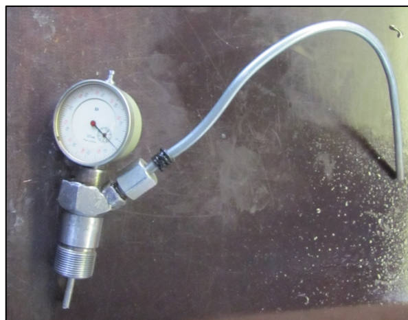
Рис. 3.208 – Приспособление для замера величины подъёма плунжера
