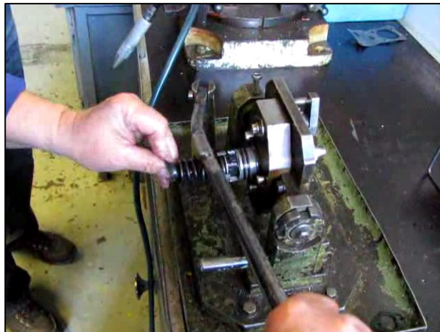
Рис. 3.51 – Снятие нижней тарелки пружины секции ТНВД
