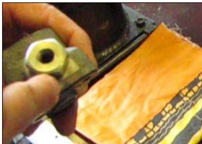
Рис. 3.137 – Оценка загрязнённости сетчатого фильтра
