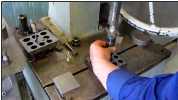
Рис. 3.74 – Проверка подвижности плунжера
