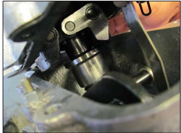
Рис. 3.188 – Соединение муфты и державки грузов
