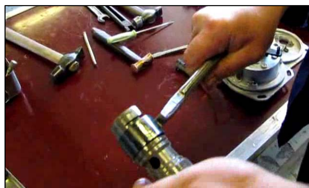
Рис. 3.56 – Снятие экрана секции
