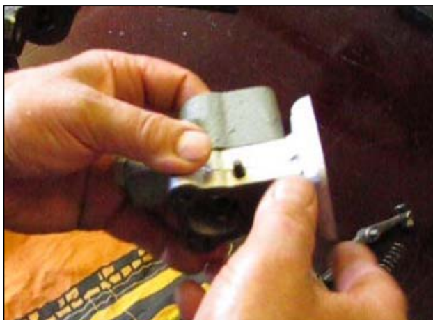
Рис. 3.140 – Установка корпуса мембраны
