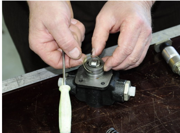
Рис. 3.79 – Снятие фиксатора толкателя
