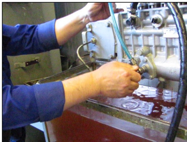
Рис. 3.206 – Присоединение дренажной трубки к масляной полости
