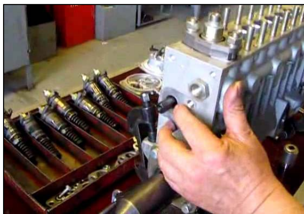
Рис. 3.182 – Проверка плавности перемещения рейки
