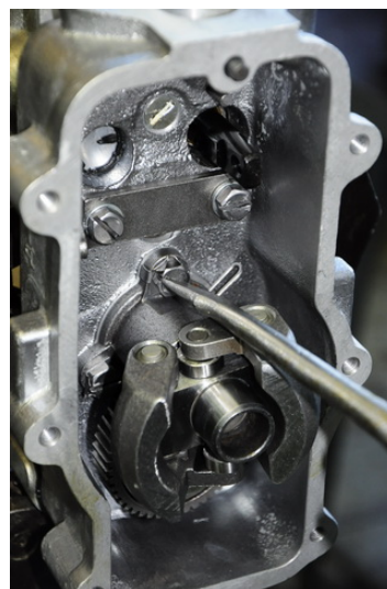
Рис. 3.183 – Установка державки грузов
