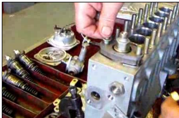
Рис. 3.180 – Установка прижимного фланца
