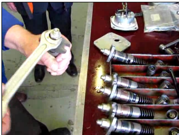
Рис. 3.52 – Демонтаж штуцера секции
