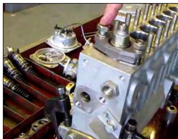
Рис. 3.181 – Затяжка гаек крепления прижимного фланца
