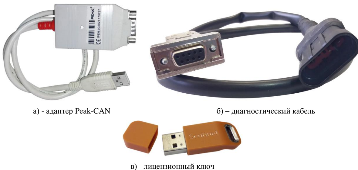
Рисунок 58 – Комплект оборудования для диагностики системы SCR производства ООО «МГС»
