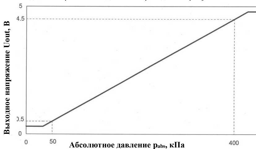
Рисунок 17 - Характеристика датчика давления при U_S = 5,0 В
