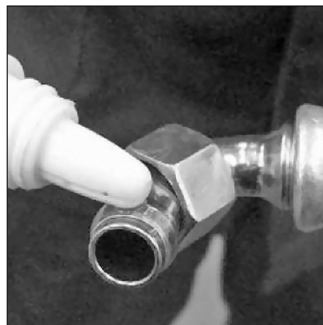
Рис. 142. Смазка ниппеля трубки подвода охлаждающей жидкости к турбокомпрессору.
