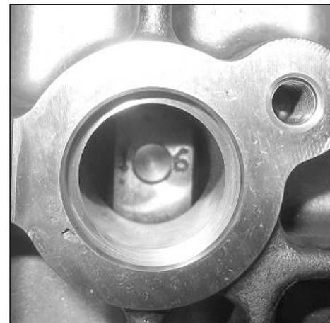
Рис. 127. ВМТ первого и шестого цилиндров
