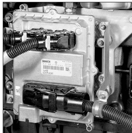
Рис. 85а. Электронный блок управления.
