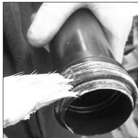
Рис. 136. Установка и смазка уплотнительного кольца трубы подводящей насоса водяного.
