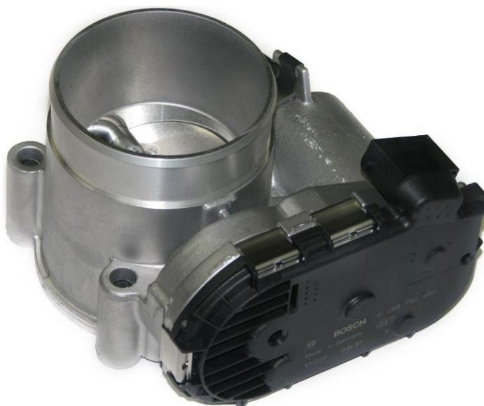
Рисунок 56 - Дроссельная заслонка с датчиком положения
