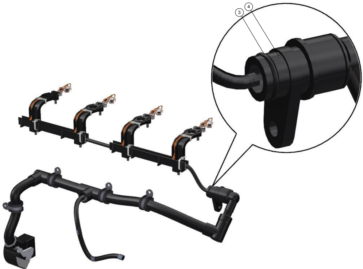
Рисунок 1 Схема прокладывания проводов жгута инжекторов в кронштейнах
