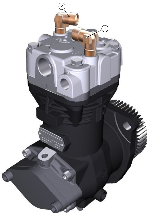
Рисунок 1 Установка угольников подвода, отвода охлаждающей жидкости к воздушному компрессору.
