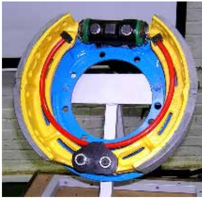
Рис. 8 Суппорт тормоза с клиновым механизмом в сборе
