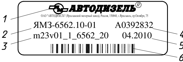
Рис. 39. Наклейка на ЭБУ M230.E3 двигателя ЯМЗ-6562.10-01
