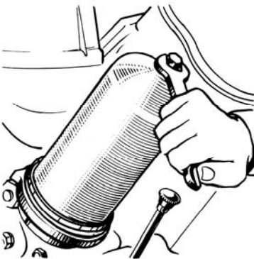
Рис. 61. Отвертывание колпака фильтра
