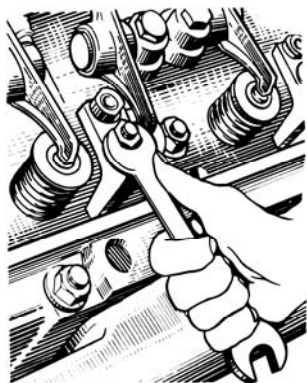
Рис. 81. Отвертывание гайки скобы крепления форсунки
