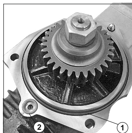
Рис. 112. Установка компрессора воздушного.
