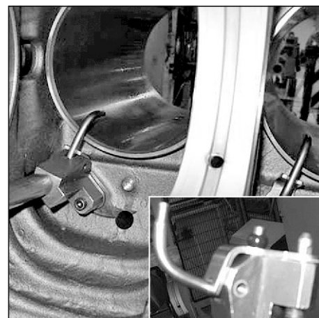
Рис. 96. Установка форсунки охлаждения поршня.
