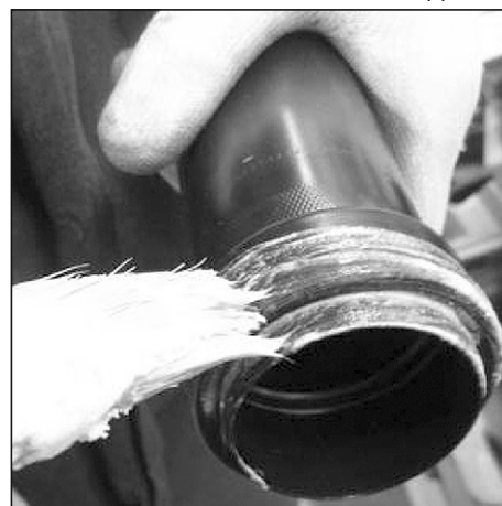
Рис. 130. Установка и смазка уплотнительного кольца трубы подводящей насоса водяного.
