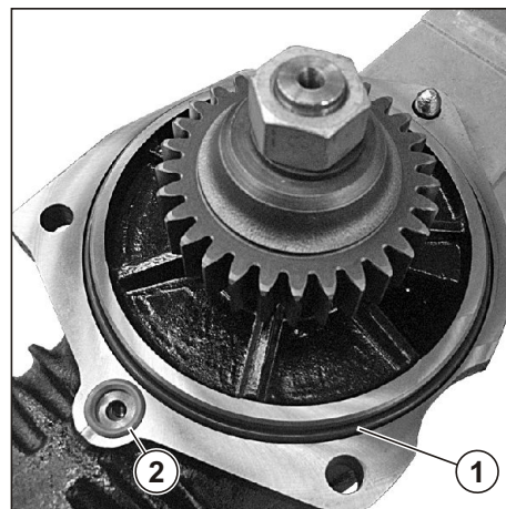
Рис. 112. Установка компрессора воздушного.
