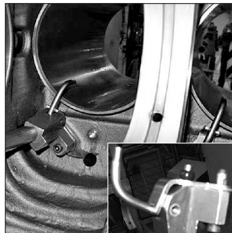
Рис. 96. Установка форсунки охлаждения поршня.
