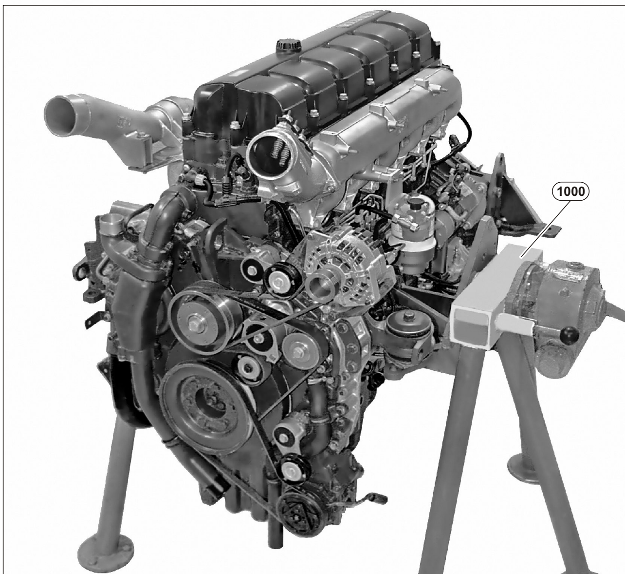
Рис. 7. Установка двигателя на универсальную стойку.
