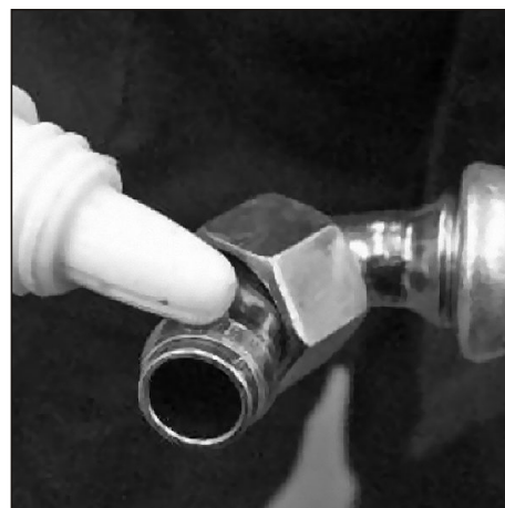
Рис. 136. Смазка ниппеля трубки подвода охлаждающей жидкости к турбокомпрессору.
