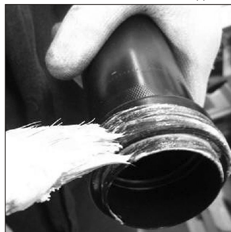
Рис. 130. Установка уплотнительного кольца трубы подводящей насоса водяного.
