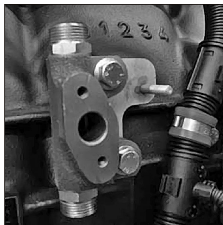
Рис. 126. Установка корпуса датчика давления и температуры топлива.
