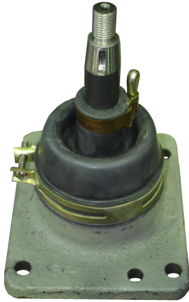
Рисунок 17 – Внешний вид рычага переключения передач с опорой в сборе КП типа ЯМЗ-239-03
