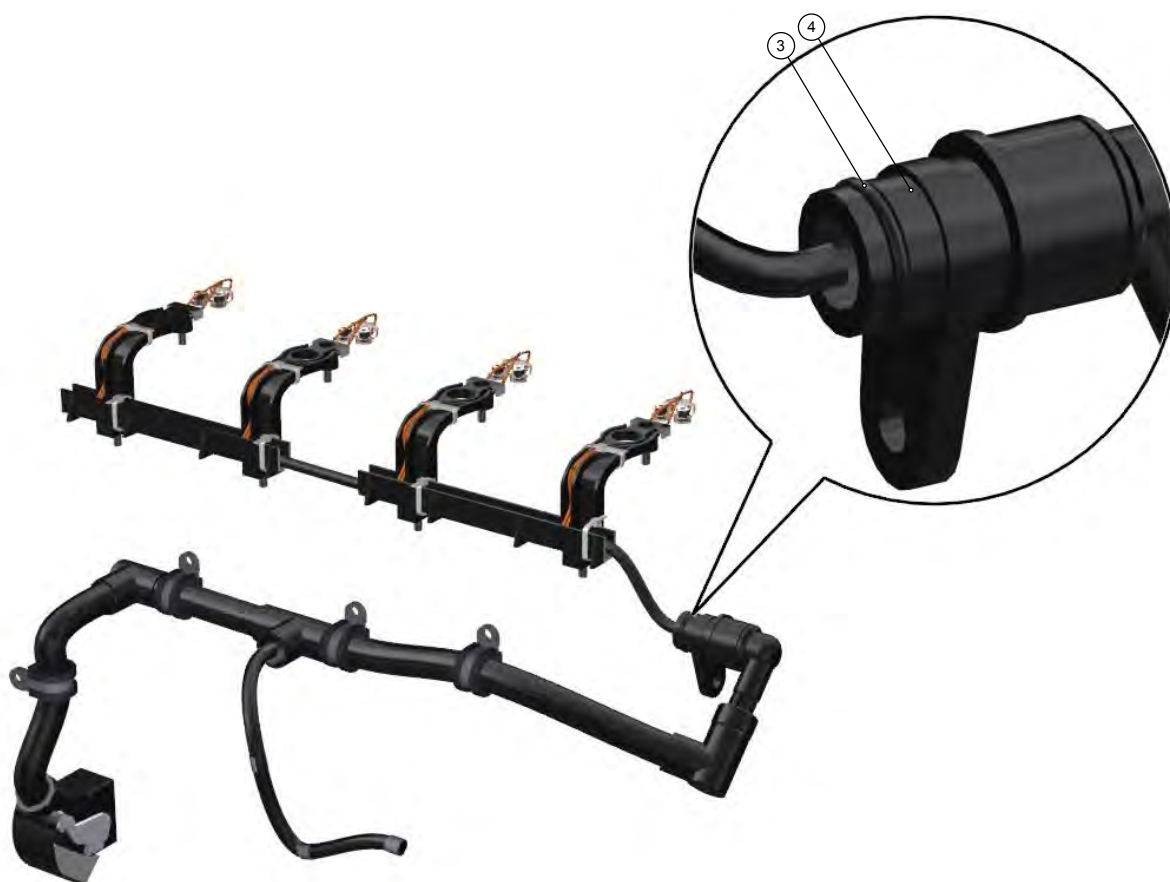
Рисунок 1 Схема прокладывания проводов жгута инжекторов в кронштейнах
